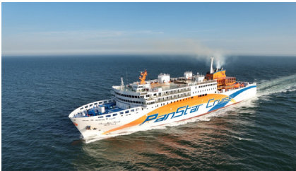
M/V PANSTAR MIRACLE Gross Ton : 22,129M/T L.O.A : 171.20M Speed : 27.39kn Cargo Capacity : 254TEU
